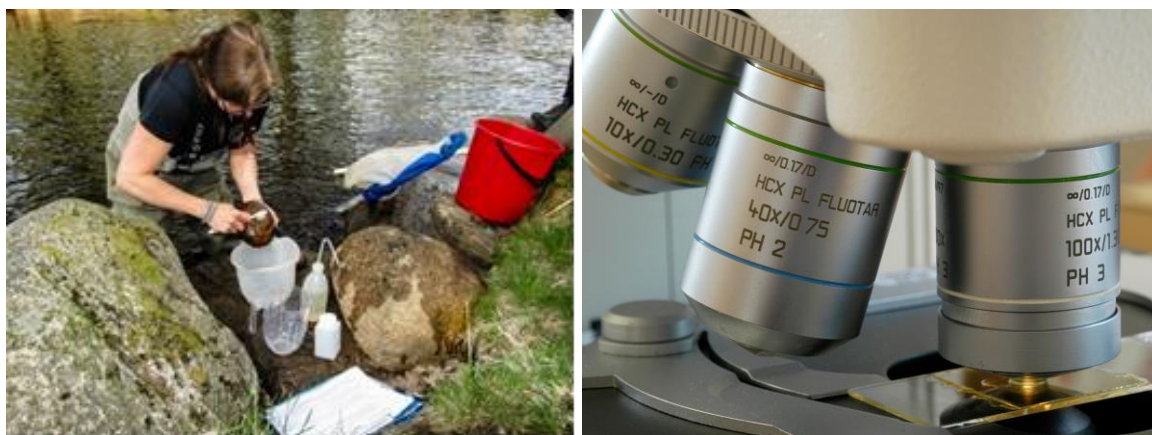
Figur 26. Provtagning av kiselalger görs i första hand genom borstning av stenar varefter kiselalgspreparat framställs och analyseras i ljusmikroskop med 1000 gångers förstoring (objektiv 100x), © Sweco Sverige AB
